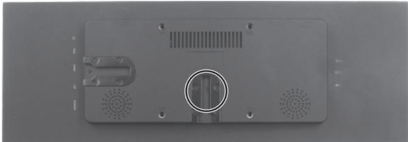
②デスクトップ用スタンドのクイックレバーを引いた状態で、クイックシューを引き上げて取り外し、クイックシューの金属プレートを緩め、本体のスタンドガイドに金属プレートをスライドさせるように取り付け、固定用のネジをコイン等で回して固定してクイックシューを本体に取り付けてください。
